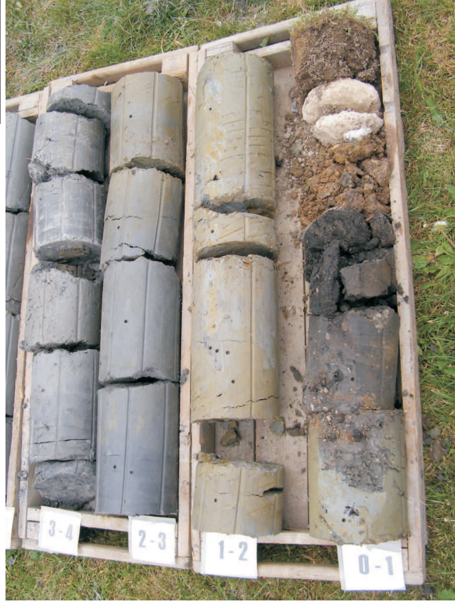
Detailní pohled na svrchní partie vrtného výnosu na vrtu J1
