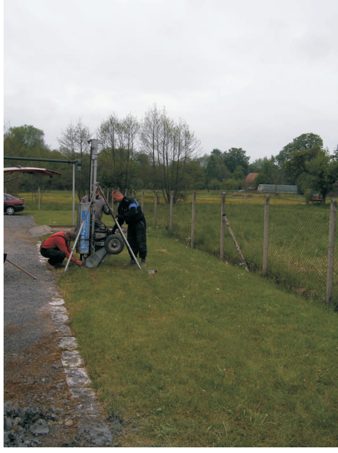
Provádění těžké dynamické penetrace na sondě DP1
