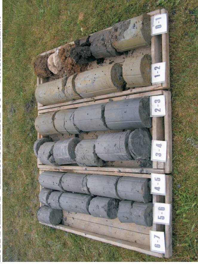
Souvislý vrtný výnos na vrtu J1 (06,20 - 00,00 m)
